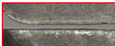
Krawędź skrawająca mniej podatna na powstawanie karbu podczas obróbki stali nierdzewnych
